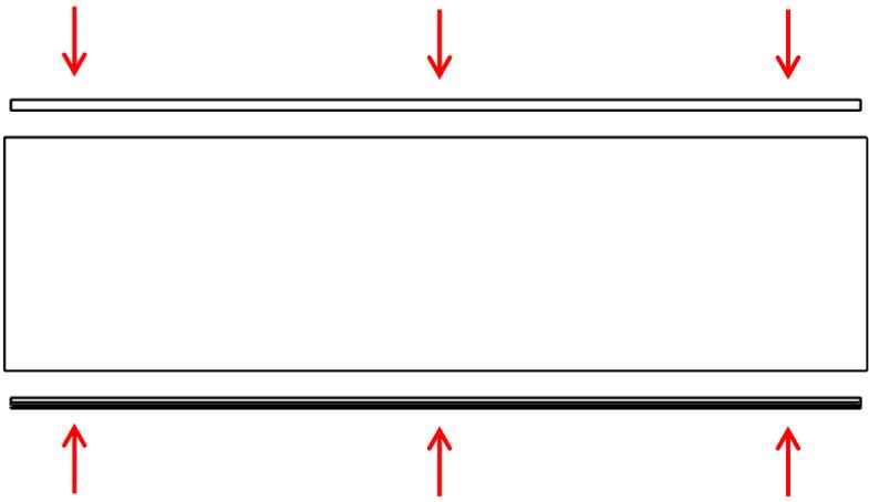
*Равномерно распределить стеклопакет относительно створочного профиля*
