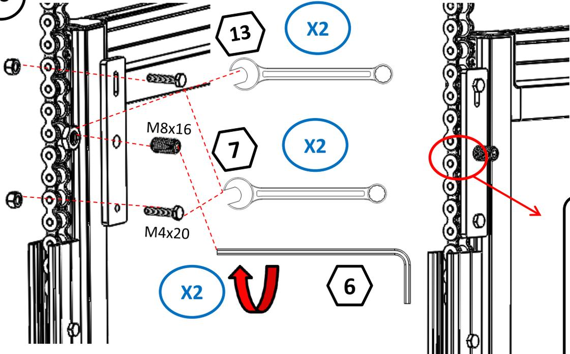
Механизм регулировки подвижной створки по горизонтали.
