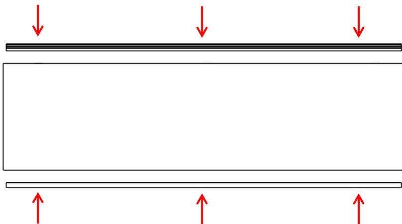
*Равномерно распределить стеклопакет относительно створочного профиля*
