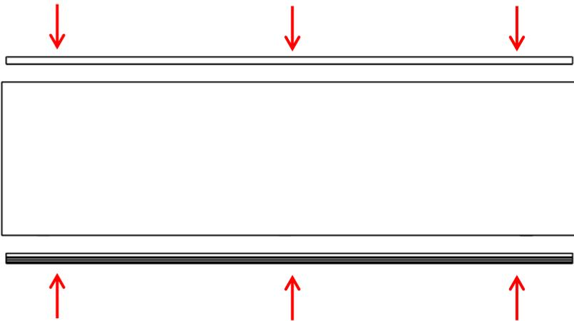
*Равномерно распределить стеклопакет относительно створочного профиля*
